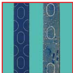
Alteración del aspecto del aluminio anodizado a color ya con alcalinidad media
