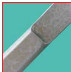
Manchas provocada por los ácidos silícicos en el condensado del vapor.
