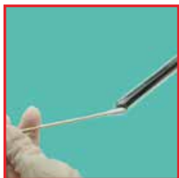
Limpieza del objetivo de un endoscopio
