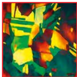
Alteración de los colores: microestructura austenítica de acero para instrumentos resistente a la corrosión y al ácido (imagen con 500 aumentos)
