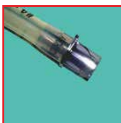
Grieta por tensión
