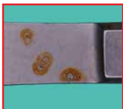
Detalle de las pinzas: Transición muelle/superficie adherente. Sal regeneradora con cloruros ha producido una corrosión de picadura masiva sobre la superficie del instrumento. Causa: conexión no estanca del intercambiador iónico al aparato de limpieza y desinfección.
