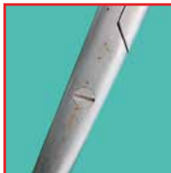
Ejemplo de corrosión de picadura
