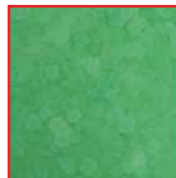
Ataque al material de la superficie de aluminio anodizado natural/ metalizado en contenedores. Causa: solución de lavado con niveles de alcalinidad no permitidos
