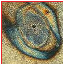
Ejemplo de corrosión de picadura
