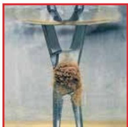
Formación de óxido por inmersión durante varias horas en una solución de cloruro de sodio
