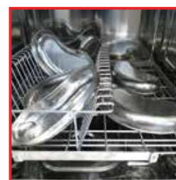
Carga equivocada/bandejas riñoneras volcadas
