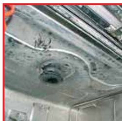
Cámara de aclarado con intensa calcificación
