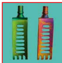
Fragmento: válvulas de titanio Válvula izquierda: nueva de fábrica. Válvula derecha: limpiada a máquina.
