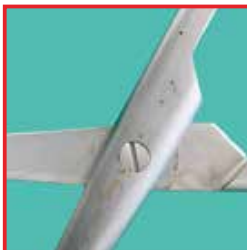
Tijeras con corrosión de picadura
