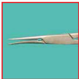
Deformación por un manejo inadecuado
