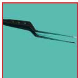
Deformación por un manejo inadecuado
