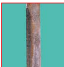
Punzón de huesos, la superficie de deslizamiento de la pieza corredera muestra corrosión por fricción
